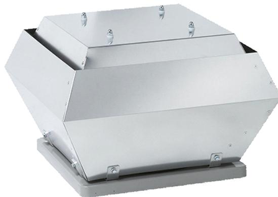
**Двигатель:** Вентиляторы DVC оборудованы энергосберегающими высокоэффективными ЕС-двигателями с внешним ротором. Электродвигатели с рабочим колесом с загнутыми назад лопатками начиная с типоразмера 355 монтируются на высокоэффективных виброизоляторах. Двигатели оснащены электронной системой защиты от перегрева электродвигателя, дополнительные средства защиты не требуются.
